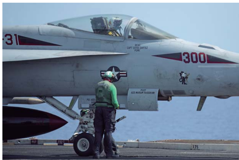
Un "chaqueta verde" guía un "Super Hornet" del VFA-87 "War Party" a la posición para su lanzamiento, en la cual casi está para que sea seguro. A continuación, un marinero se comunicará con el piloto para discutir el peso del avión para que la catapulta tenga suficiente potencia (foto Jurgen van Toor).
