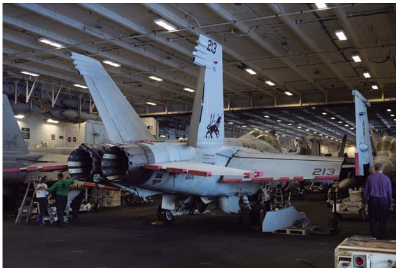
"Green Jackets" realizando tareas de mantenimiento en el gran hangar del FA-18E con serial AJ-410. El espacio aumentó aproximadamente un 25 por ciento en comparación con el disponible en los portaaviones de la Clase "Nimitz". El área adicional se necesita, entre otras cosas, para el motor del F-35, pero también para futuras operaciones de vehículos aéreos no tripulados (foto Patrick Roegies).
