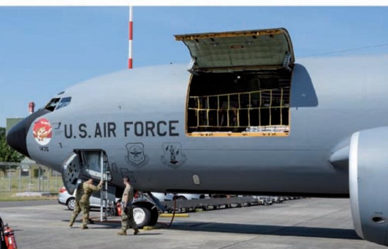
Die aus der Boeing 707 abgeleiteten Tanker KC-135 besitzen auch eine große Frachtluke. Die Besatzung klettert über eine Leiter ins Flugdeck.
