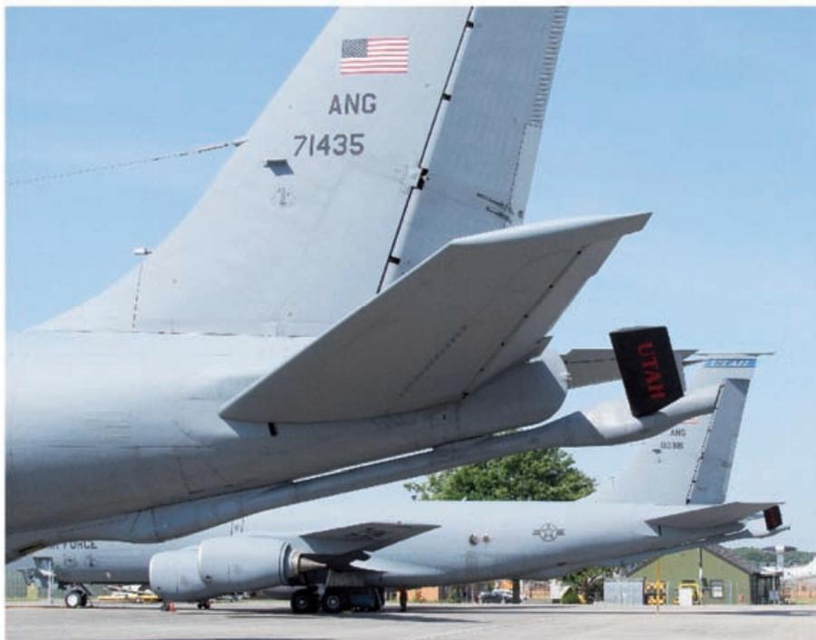
Der Betankungsarm der KC-135 verfügt über zwei kleine, bewegliche Flügel mit denen die Bewegung des Tankers gegenüber dem Treibstoff übernehmenden Flugzeug ausgeglichen werden.
