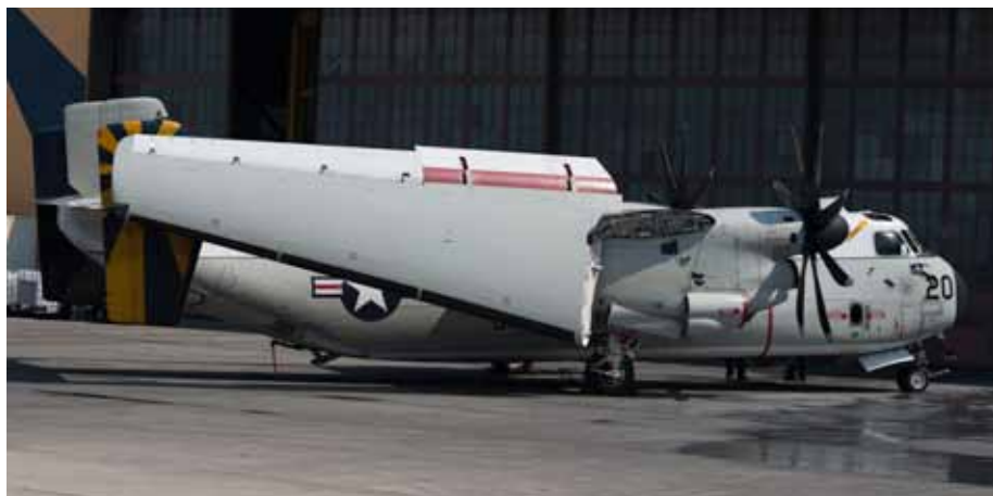
Mit ihren klappbaren Tragflächen lässt sich die Greyhound auch unter Deck verstauen.
