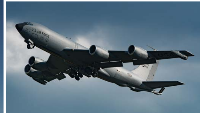
【上2枚】 上はシュバンダーレムABを離陸するVAQ-134のEA-18G。全見開き写真の機体と同様、同隊側面のステーションに自衛用のAIM-120C AMRAAM中距離空対空ミサイルを搭載している。下は、同隊と同様にワシントン州フェアチャイルドAFBから遠征空中給油部隊としてシュバンダーレムに派遣されているAMC (航空機動軍団) 92ARWのKC-135R。主翼下に装備されたドロッグポッドに注目。
