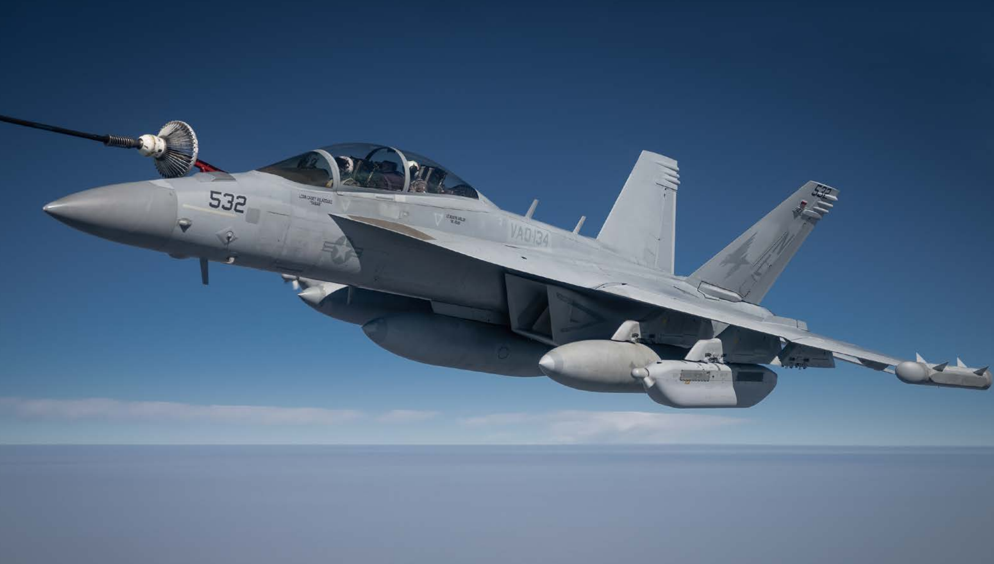
↑ KC-135Rの主翼端に搭載されたドロッグポッドから給油を受けるVAQ-134のEA-18G。基本的には複座型スーパーホーネット、F/A-18Fと同じエアフレームだが、機首のM61A1 20mm機関砲は搭載されておらず、後部胴体にも電子戦用機器が追加搭載されている。最大の外見上の特徴は、AIM-9用ランチャーに換えて主翼端に装備されたAN/ALQ-218(V) 2受信アンテナ。
